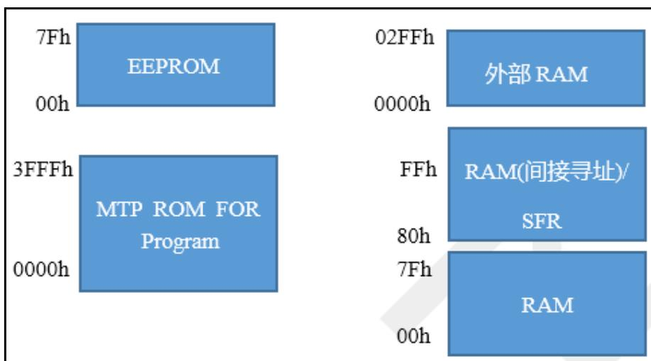
图 8-4 MTP 与 SRAM 结构图
