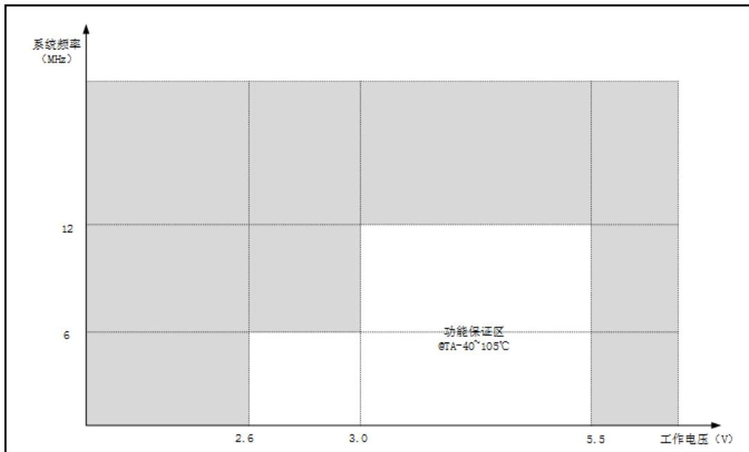
图 12-1 工作频率与电压对应关系
