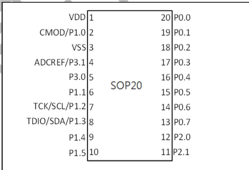
图 4-3 SOP20 封装脚位图(支持引脚功能全映射)
