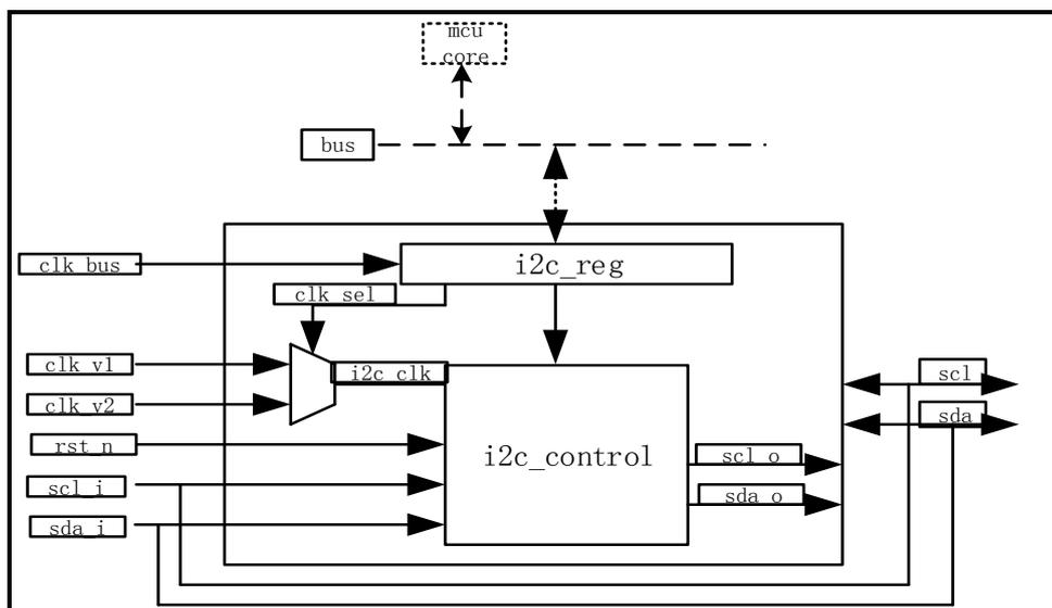
图 10-10 I2C 结构框图
