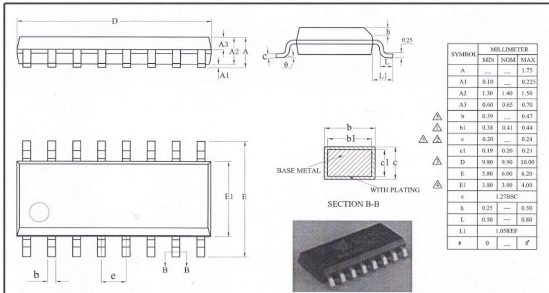
图 1-2 SOP16 封装 POD 图
