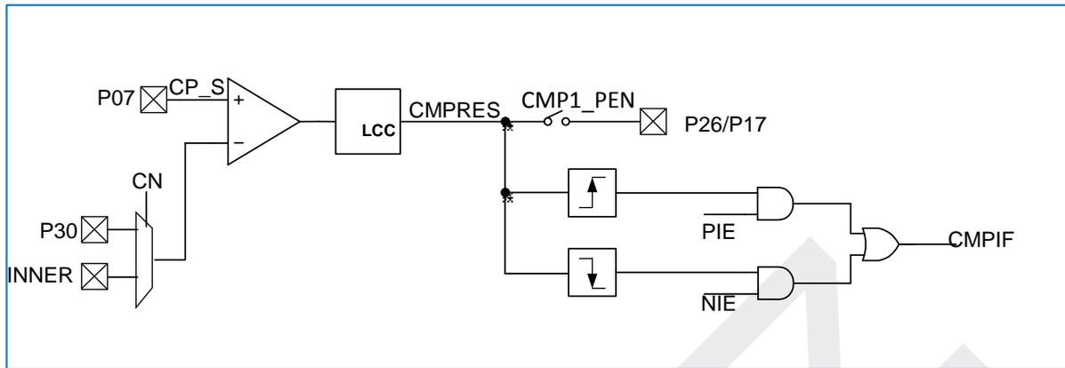
图 10-20 比较器 1 电路结构框图
