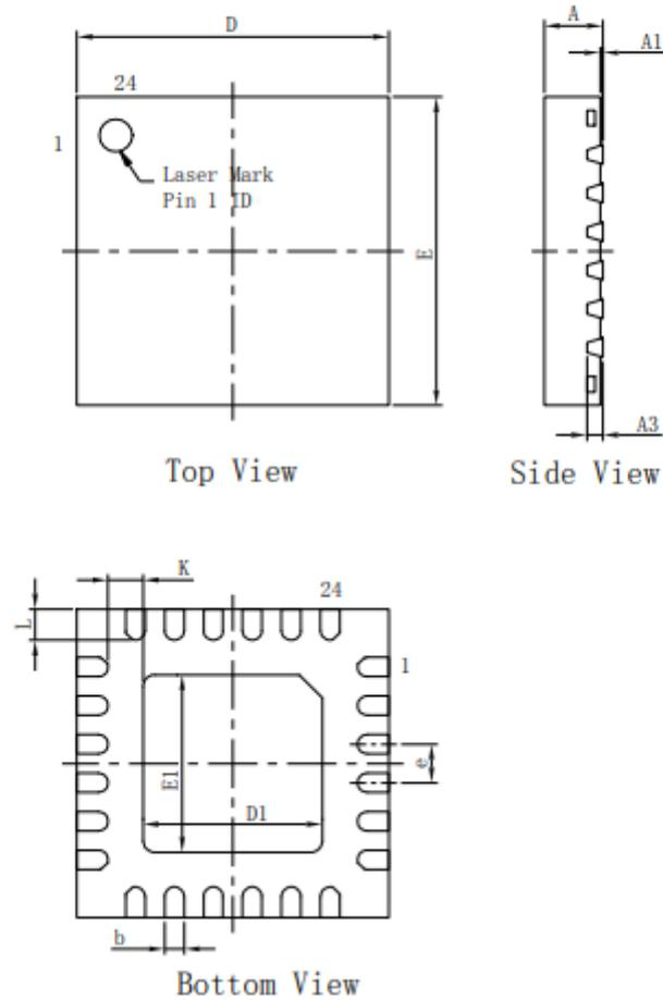
图 16-2 QFN24 封装外形图
